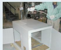
脱脂が完了したら、エポキシ樹脂塗料を塗り重ねていきます。乾燥するまで時間がかかるため、数日にわけて塗り重ねていきます。
