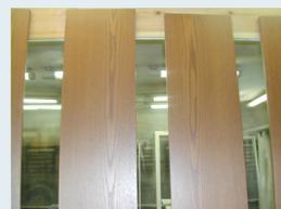
OSCL仕上げなので、まず生地を染色していきます。その後乾燥させます。
