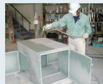
膜圧計で指定の膜圧が出ている事を確認できたら上塗りを塗装していきます。
